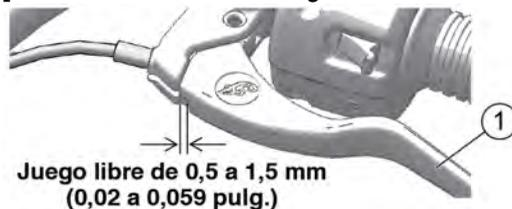
2. El juego libre (espacio libre) es la cantidad de movimiento de la palanca desde la posición de descanso hasta el punto de resistencia del cable. El juego libre de la palanca del embrague debe ser de 0,5 a 1,5 mm. Mida el espacio libre entre la palanca del embrague y la caja de la palanca. Vea la página 96. Si es necesario, ajuste el juego libre de la palanca del embrague.
